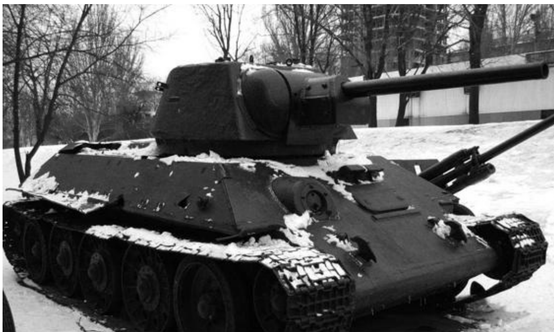
T-34 soviético armado con cañón de 76 mm. Unía movilidad, potencia de fuego y blindaje, y además era un blindado robusto y fácil de fabricar. Se fabricaron 57 000 unidades que combatieron en todas las batallas del frente ruso, desde Moscú y Stalingrado hasta Kursk y Berlín (AXH).
